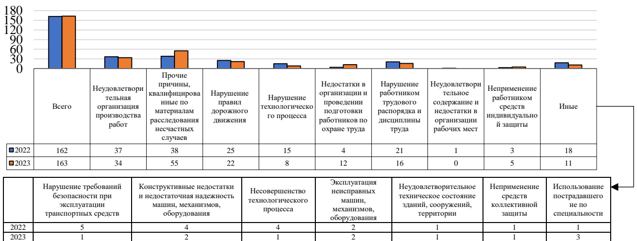
Рисунок 2.159 – Распределение несчастных случаев с тяжелыми последствиями по причинам происшествий в Нижегородской области в 2022 и 2023 годах (по данным Роструда)
