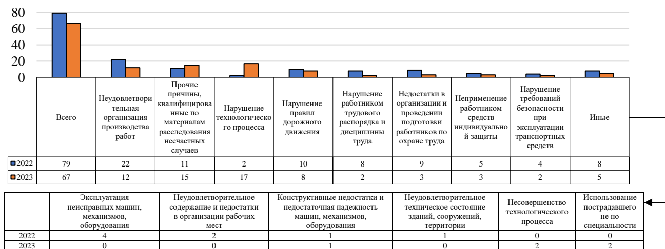
Рисунок 2.189 – Распределение несчастных случаев с тяжелыми последствиями по причинам происшествий в Хабаровском крае в 2022 и 2023 годах (по данным Роструда)
